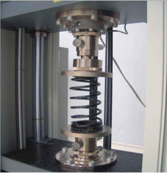
Amortisör yay basma testi
