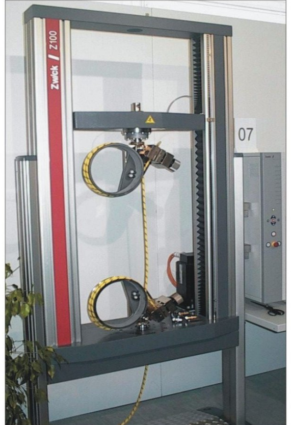
Sarmal (roller) çenelerle halat çekme testi
